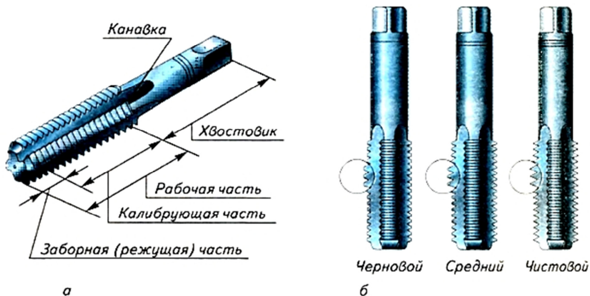
Рис. 81. Метчики: а — основные элементы; б — комплект для нарезания метрической резьбы
